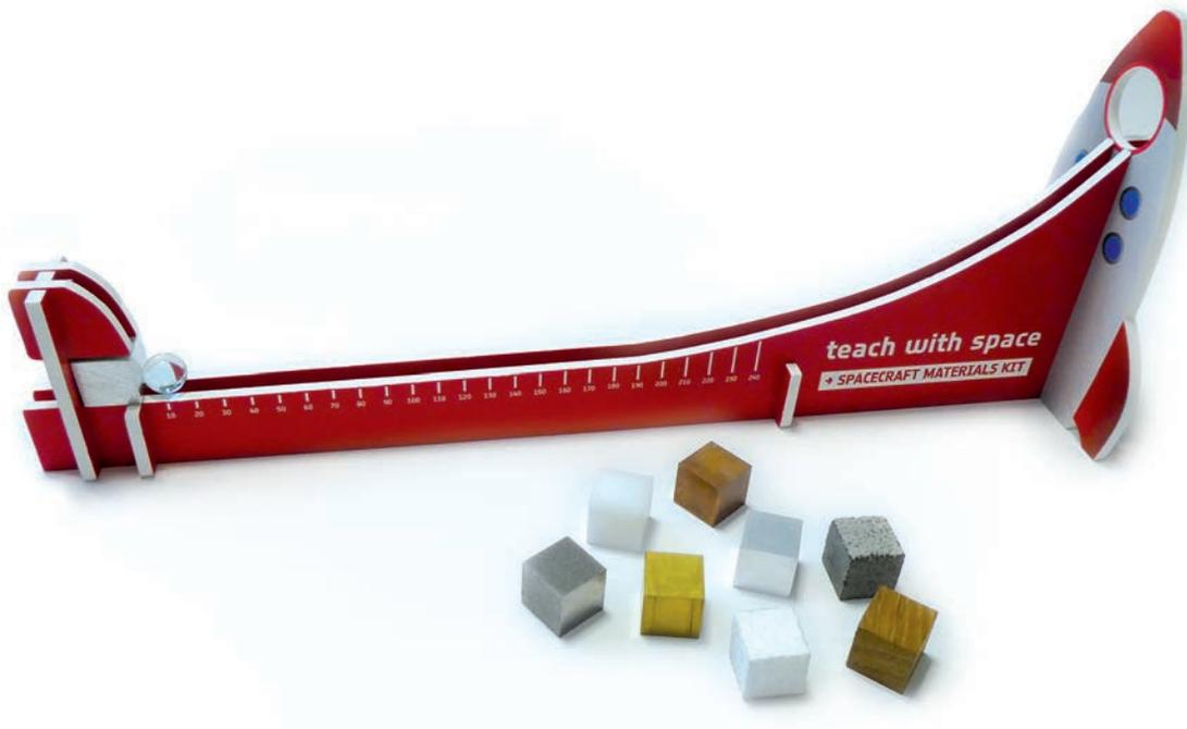
Rampa para comprobar la resistencia a impactos.
