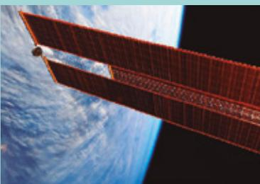
La Estación Espacial Internacional (ISS) utiliza paneles solares para obtener electricidad. La imagen de la derecha muestra algunos de los paneles solares de la ISS, donde residen hasta seis astronautas al mismo tiempo. A medida que la ISS orbita alrededor de la Tierra, los paneles solares se pueden rotar para que apunten de una forma más directa hacia el Sol. Los paneles ocupan un área de  $2500 \text{ m}^2$ , una superficie equivalente ¡al tamaño de medio campo de fútbol!
